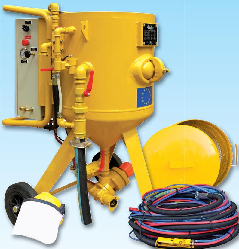
Ce système se raccorde uniquement à un compresseur ayant un débit minimum de 4.5 m<sup>3</sup>/mn ainsi qu'à une robinet de puisage d'eau.
